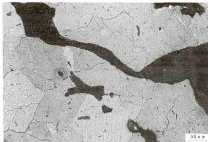
4. 积铁块样品 ZZ09 的金相组织。基体为铁素体，黑暗部分为复杂夹杂物，熟铁。
