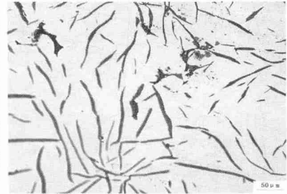
3. 积铁块样品 XG09 的金相组织。基体为珠光体组织，黑色条状物质为石墨，灰口铁。
