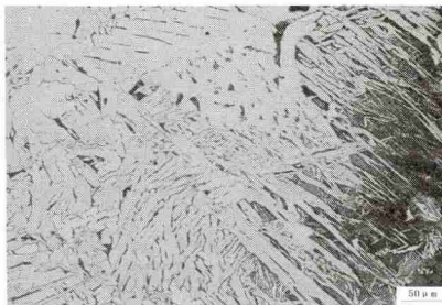
5. 炉渣样品 GTZ13 基体夹杂铁颗粒的金相组织。左上部分为铁素体，中间部分为铁素体和珠光体，右边为魏氏组织。
