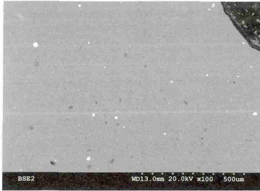
1. 炉渣样品 GDZ11 背散射电子像。灰相为玻璃态基体，亮白相为夹杂铁颗粒。
