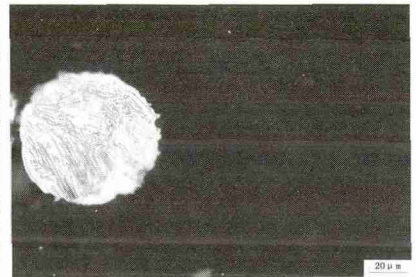
6. 炉渣样品 JD10 基体夹杂铁颗粒的金相组织，珠光体均匀分布，共析钢。
