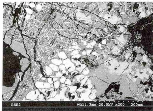
4. 炉渣样品 HZ03 背散射电子像。树枝状和块状亮白相为浮氏体，灰相为高铁玻璃态基体。
